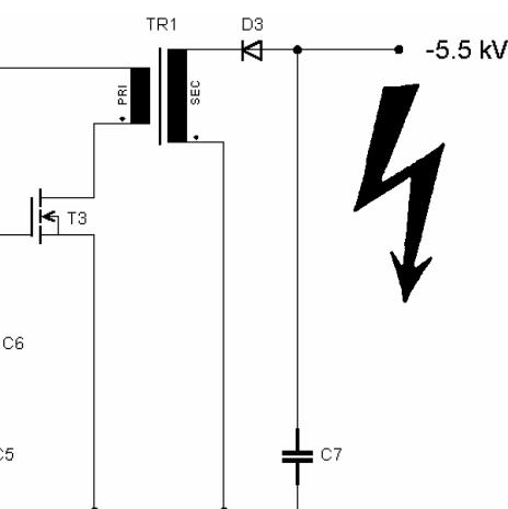
**D** Schaltungsbeschreibung: Impulsgenerator mit nachfolgendem Schaltransistor, der die Impulse auf einen Hochspannungstrafo gibt. Am Ausgang des Hochspannungstrafos ist eine Hochspannungsdiode zur Gleichrichtung mit Siebkondensator.
